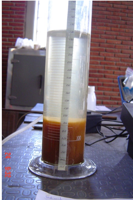
Foto 6.- Disposición de la Prueba de Probeta utilizada para determinar las Curvas de Sedimentación de los productos de la Neutralización – Precipitación
