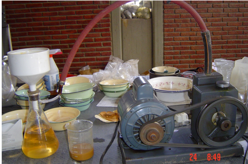
Foto 5.- Disposición del Equipo utilizado para la Filtración al Vacío de los productos de la Neutralización – Precipitación
