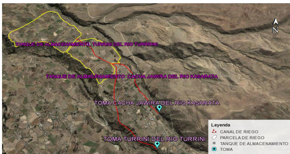
IMAGEN SATELITAL DEL SISTEMA DE RIEGO
