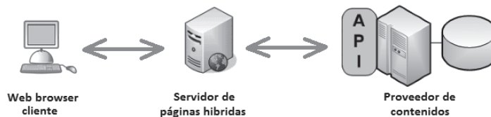
Figura 9.4. Elementos de una arquitectura mashup con API
